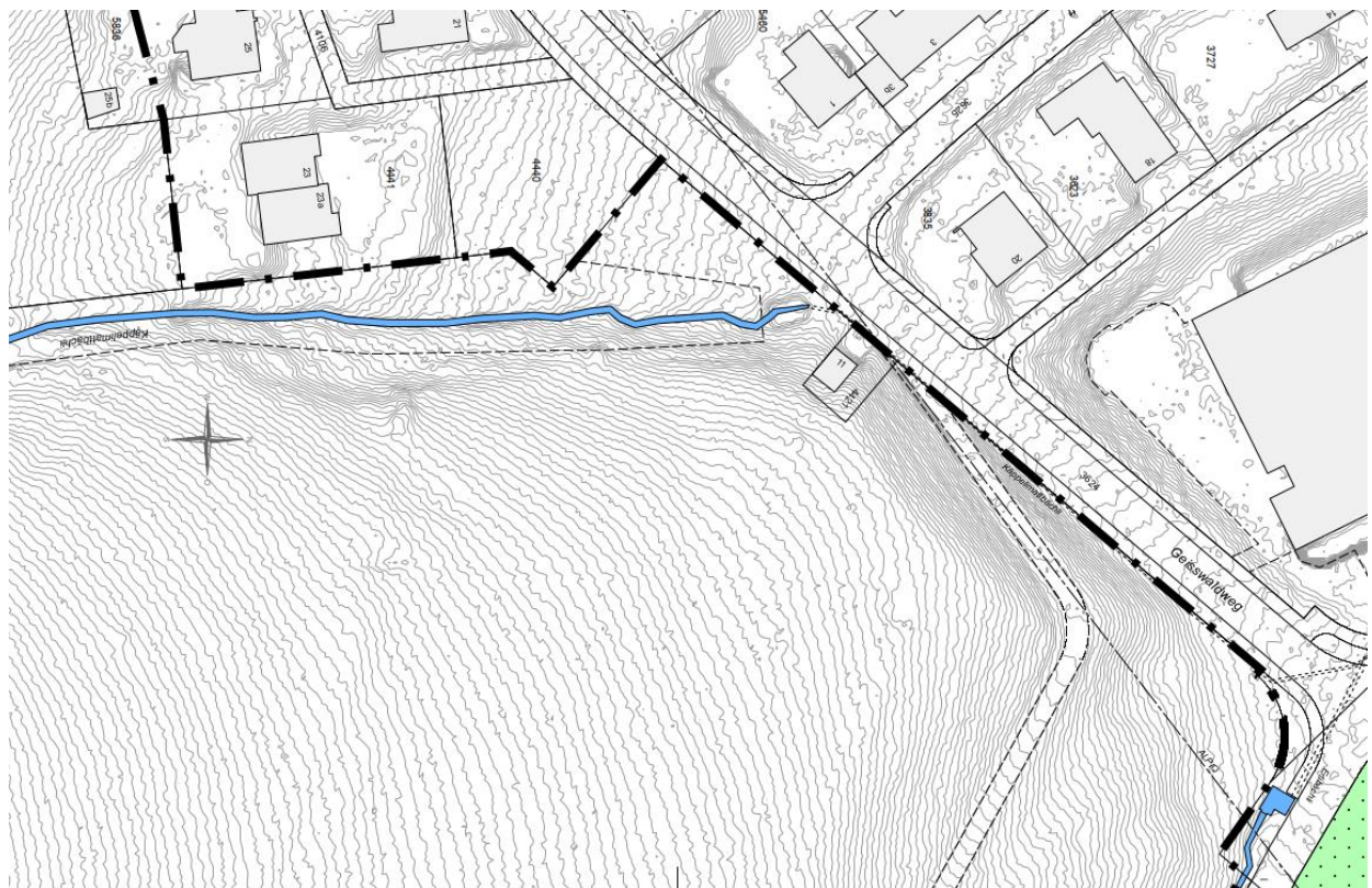
Abbildung 19: Darstellung des digitalen Terrainmodells (DTM) im Bereich des eingedolten Käppelmattbächlis entlang des Geisswaldwegs (Quelle: eigene Darstellung)
